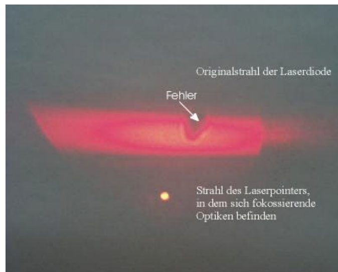
Abb.1: Originalstrahl der Laserdiode im Vergleich mit dem aus dem Laserpointer austretenden nachfokussierten Strahl. Meistens werden, wie auch hier zu sehen, in Laserpointern aus Kostengründen fehlerhafte Laserdioden eingebaut.
