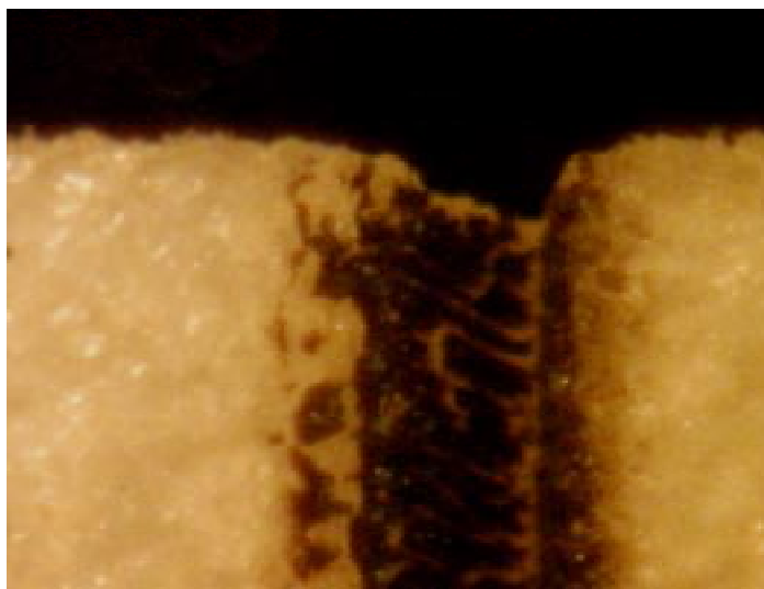
Abb. 4.4b: Deutliche Karbonisationsspuren beim Schneiden ohne Wasser. Die Schnittbedingungen sind dieselben wie in Abb. 4.4a. Die Vergrößerung beträgt 4:1.
