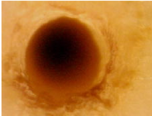
Abb.4.6a: Sowohl am Rand der Läsion als auch innerhalb des Schnittkanals sind Spuren von Karbonisation (porcine femur Kompakta: Er:YAG-Laser: 1 Hz, 360 mJ, 340 \mu s, Lochdurchmesser ca. 1 mm) unter dem Mikroskop deutlich erkennbar. Aufgrund der fehlenden Tiefenschärfe ist dies im Bild nicht deutlich auszumachen. Die Aufnahme wurde mit einer Vergrößerung von 10:1 aufgenommen.
