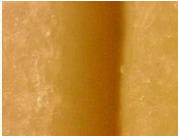
Abb. 4.4a: Aufnahme von oben in den Schnittspalt eines Schweine Oberschenkelknochens. Es ist keine sichtbare Karbonisation vorhanden. Der Schnitt wurde mit 0,9 ml/min Wasserspray gemacht ( \Phi = 9,8 \text{ J/cm}^2 , N_{eq} = 1500 ). Die Vergrößerung beträgt 10:1.
