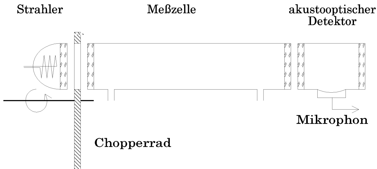
Abb.1.2: Schematischer Aufbau eines NDIR-Spektrometers (mit freundlicher Genehmigung von M. Haisch).
